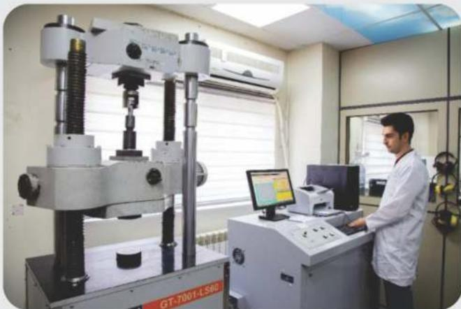
آزمون کشش ، فشار ، خمش در دمای محیط
